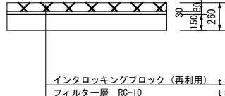
インターロッキング改修1
