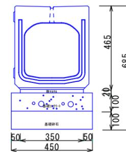
ボックス型側溝用集水樹工 材料表
