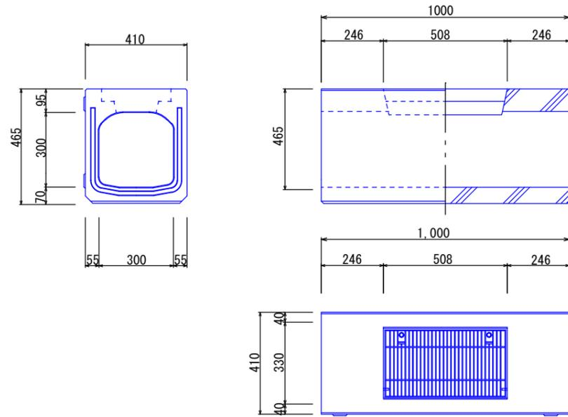
ボックス型側溝製品
