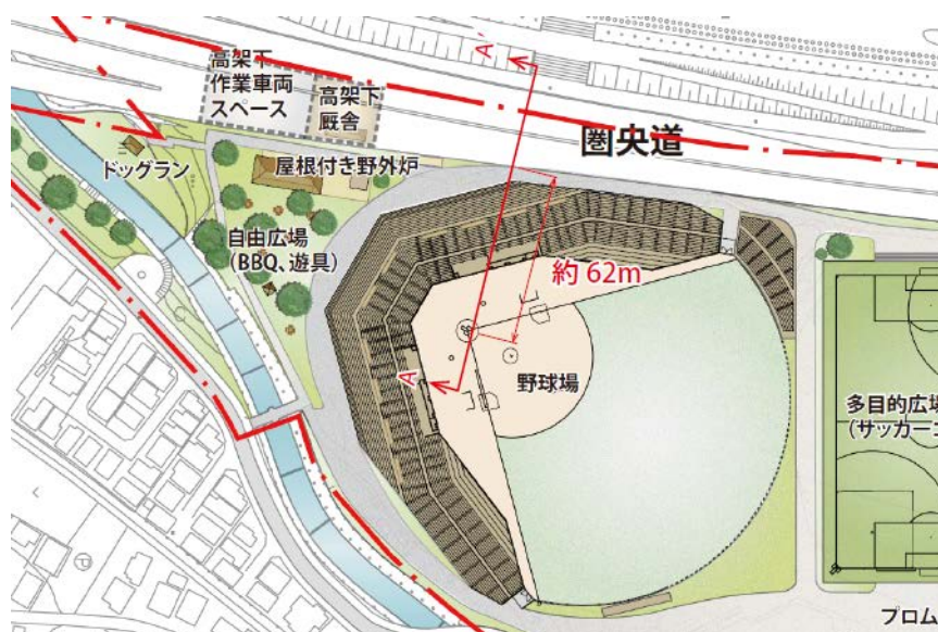
図 11.3 圏央道側の防球ネット整備例
