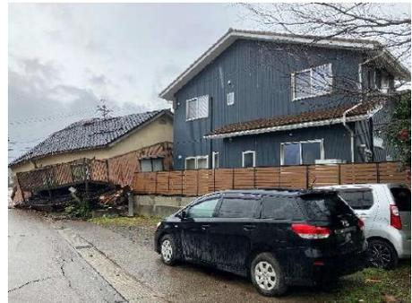
【写真左】能登半島地震で倒壊した旧耐震基準の木造住宅
