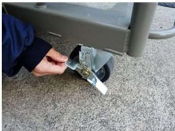
① 本体を水平な場所に設置し、キャスターのブレーキをロックします。
