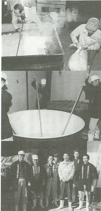
「床もみ」蒸し米とこうじ菌を混ぜ、こうじ米を作る▶ 写真上：蒸し上がった米。こうじ米、酒母、もろみに使う/同中：「かい入れ」。仕込みタンク内の温度を均一に、また二酸化炭素を放出させる/同下：橋場さん(右から3人目)を囲む蔵人たち。
