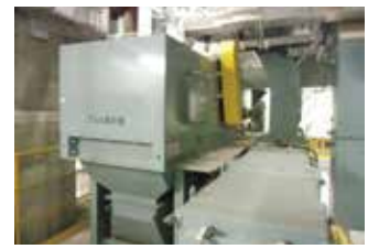
【アルミ選別機】 磁力でアルミ類を分別
