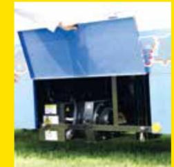
屋外で本部を設置した場合に求められる電力は、非常用発電機（PTO 駆動発電機）を供給源にし、パソコンや照明、冷暖房などの環境整備が可能に。起震室内のモニターは地デジテレビに切り替え、場面に応じてドローンと併用し情報を収集します。外部との通信用にMCA無線機を搭載しています。
