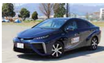
水素と酸素の化学反応によって発電した電気を使って走行する「燃料電池自動車」
