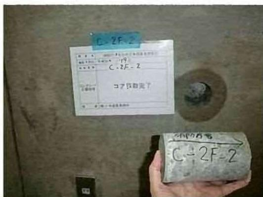
コンクリート強度試験（コア抜き）
