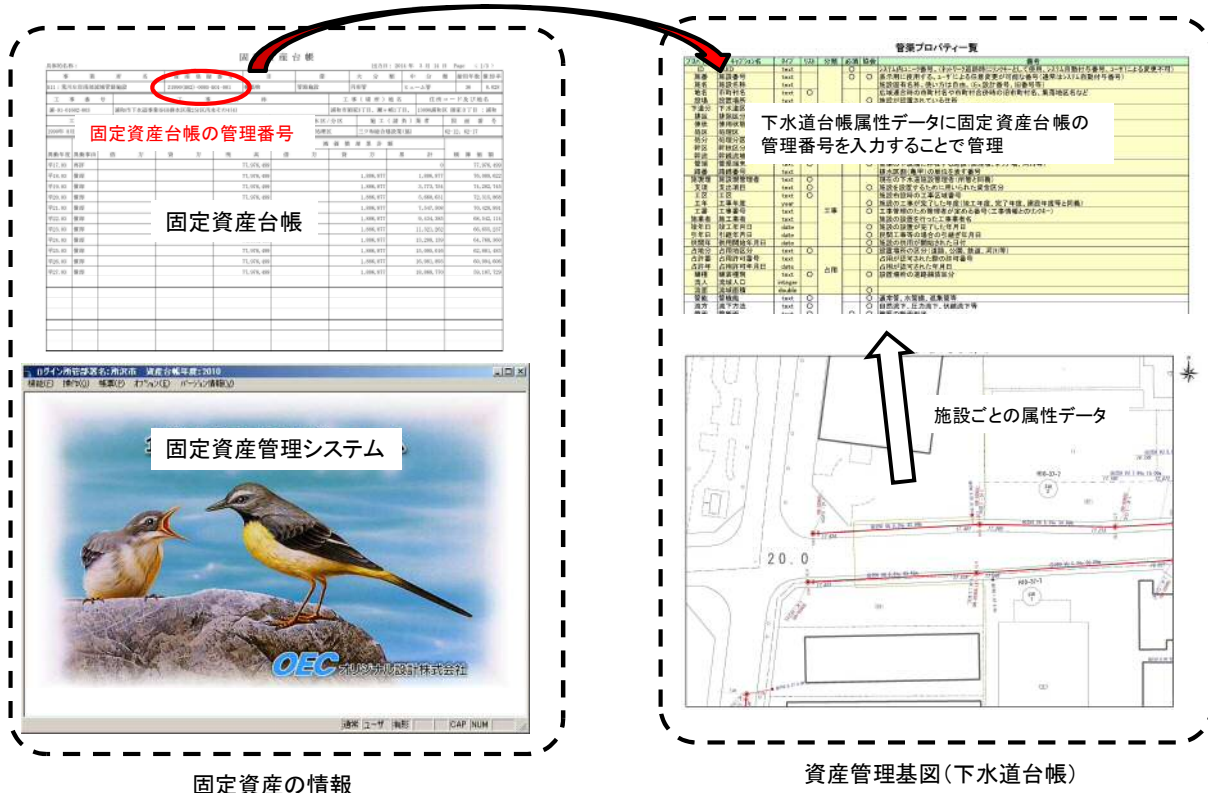
図 6.9 資産管理基図の概要図
