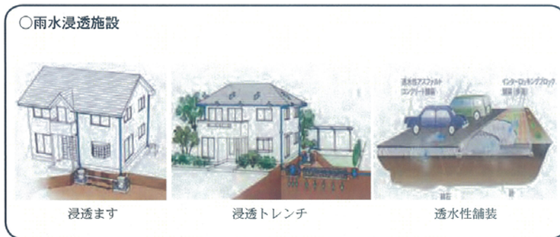
図4-4 雨水浸透施設の例
