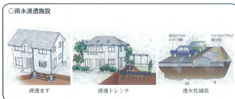
図5-5 雨水浸透施設の例
