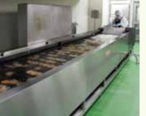
コンベア式の連続式揚物機で均一に仕上げます。焼き物や蒸し物はスチームコンベクションオーブンで調理します。
