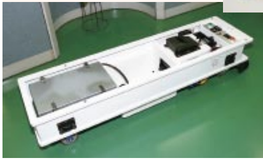
①「潜り込み型」の無人搬送車。床に埋め込まれたIDチップを感知して自動的に台車の下に潜り込み、台車の底面と連結して動かしながら荷物を運搬する
