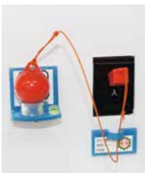
▲震度5以上の地震でボールが落ち、その重みでブレイカーが落ちる仕組み
